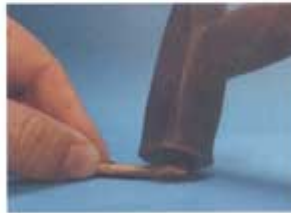
Uderzając młotkiem, rozbijamy koniec belki na strząż. Ważne żeby drewno było bardzo dobrze wysuszone.
