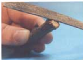
Końce drewna, szczególnie brzozy kory, powinniśmy nieco opłować, używając płaskiego pilnika do metalu.
