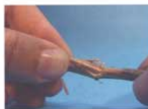
Po wyschnięciu kleju delikatnie ścinamy w odł podłużnej belki, tak aby uporzadkować jej rozmiar od wewnątrz.
