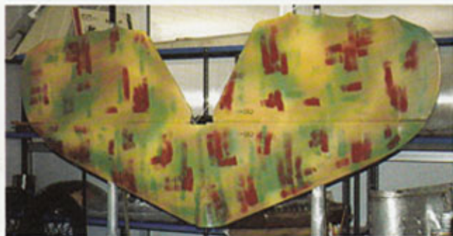
Стабилизатор истребителя Ансальдо «Баллила» - пример итальянского трехцветного камуфляжа.
