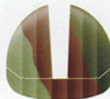
Оперение «Фоккера» D.VII в камуфляже, применявшимся фирмой «Фоккер» в конце 1917 - начале 1918 года.
