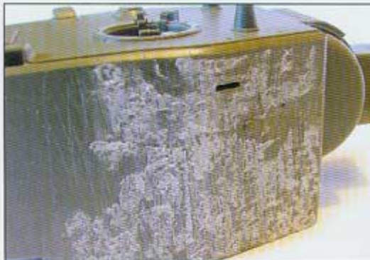
2 Po wyschnięciu kleju przy pomocy ostrego nożyka zdarłem papier. Tam, gdzie klej nie przykleił chusteczki pozostały placki.
