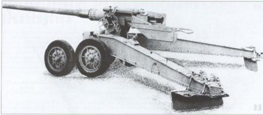
66. 128-мм орудие К 81/1 фирмы Крупп – ствол PaK 80, установленный на лафет трофейной французской 155-мм пушки Canon de 155-mm Grand Puissance Filoux (АСКМ).
